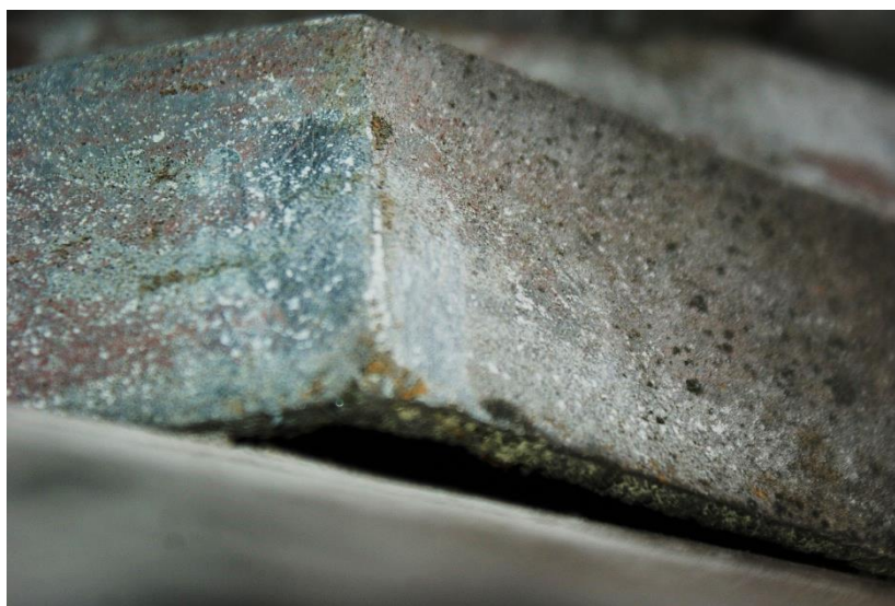
3. korozja na powierzchni cynkowej blachy, charakterystyczne białe kropki tzw. polka pots
